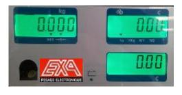
Afficheur vendeur et client LCD (digits de 14,5mm). Rétro-éclairage sur afficheur avant.
